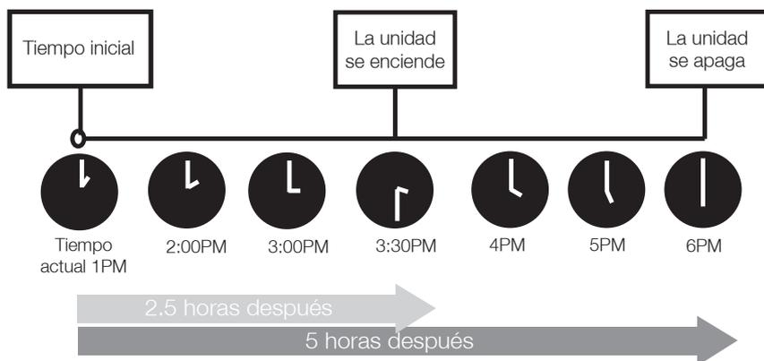
Ejemplo: si el temporizador actual es la 1:00 p.m., para configurar el temporizador como los pasos anteriores, la unidad se encenderá 2.5 h más tarde (3:30 p.m.) y se apagará a las 6:00 p.m.
