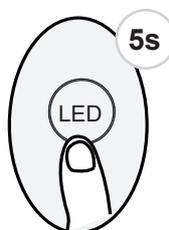
Mantenga presionado este botón más de 5 segundos, la unidad interior mostrará la temperatura ambiente real. Presione más de 5 segundos nuevamente para volver a mostrar la temperatura configurada (depende del modelo).
