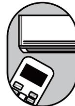
Pulse Temp. arriba o abajo varias veces para configurar el tiempo deseado para encender la unidad.
