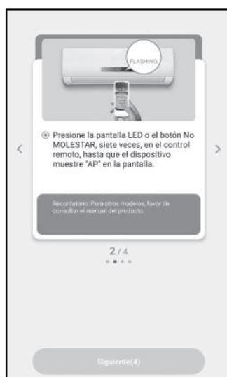
6. Coloque el equipo en modo AP, presionando 7 veces el botón "LED" o "No Molestar" (Do Not Disturb) del control remoto. El display del equipo mostrará AP.
